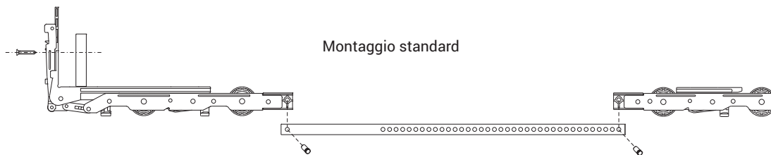
Montaggio con 1 carrello supplementare (300 kg)
