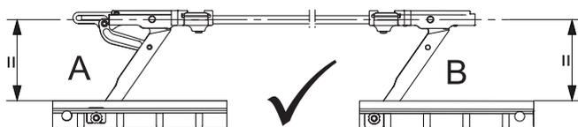
Параллельность створки и рамы с ножницами
