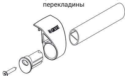
Установка заглушки, закрывающей торцы переключателя
